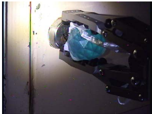
1. TIP室扉鍵開け作業
